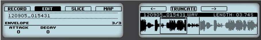
Die EDIT-Page auf dem Controller, Page 3 von 3: Die Lautstärke-Hüllkurve eines Samples.
