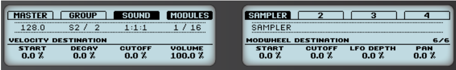
Sampler-Parameter – Page 6 von 6: VELOCITY DESTINATION und MODWHEEL DESTINATION auf dem Controller.
