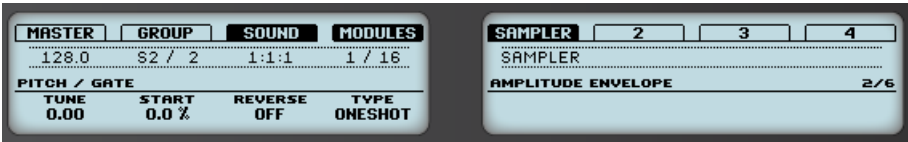
Sampler-Parameter – Page 2 von 6: PITCH / GATE und AMPLITUDE ENVELOPE auf dem Controller.
