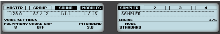
Sampler-Parameter – Page 1 von 6: VOICE SETTINGS und ENGINE auf dem Controller.
