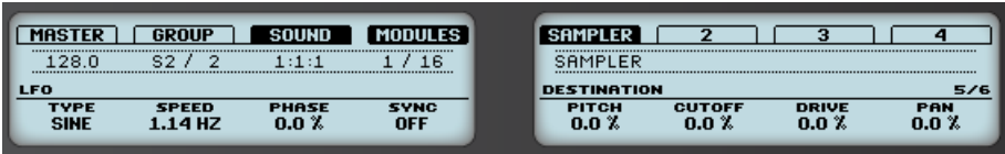
Sampler-Parameter – Page 5 von 6: LFO und DESTINATION auf dem Controller.
