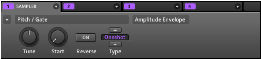
Sampler-Parameter – Page 2 von 6: Pitch / Gate und Amplitude Envelope in der Software.
